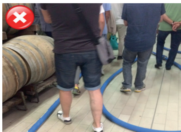
Figura 8. Nelle aziende vitivinicole assicurarsi che non vi siano tubazioni stese sul pavimento.
